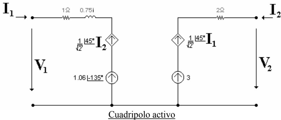
La representación de la red mediante su circuito equivalente en  $T$  es:
