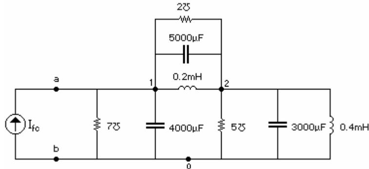
**Solución:** La terminal “a” deberá ser el nodo 1, donde se conecte la fuente de corriente.
