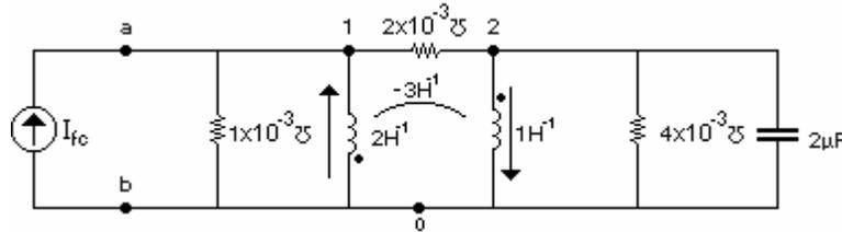
**Solución:** Se conecta una fuente de corriente  $I_{fc}$  entre las terminales *a* y *b*. Se tendrá la terminal “*a*” conectada al nodo 1 y la terminal “*b*” a la base de la componente. Se observa que por tener una invertancia mutua negativa la inductancia mutua ha de ser positiva, por lo que el sentido de los elementos es el que se muestra.
