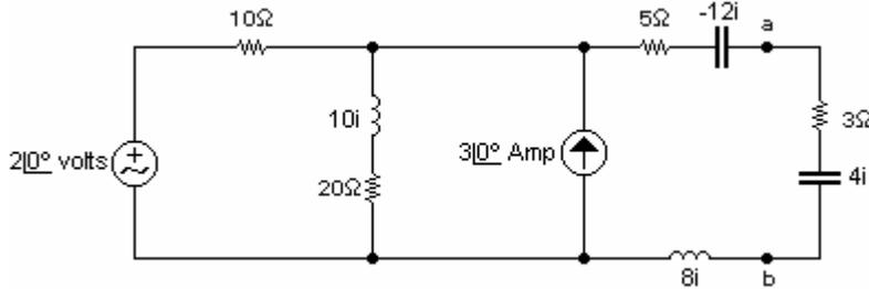
**Solución:** Separamos la carga de  $3+4i$  y cortocircuitamos las terminales *a* y *b*.
