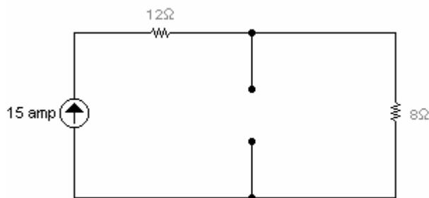
En C.D. no circula corriente por el capacitor, por comportarse como circuito abierto.
