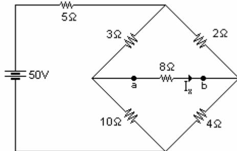
**Solución:** Habiendo separado el resistor de  $8\Omega$ , se tendrá la malla 2. Habremos de calcular  $V_{ab} = V_{Th}$ .
