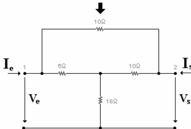
$$\text{RED "A": } \begin{bmatrix} V_1 \\ V_2 \end{bmatrix} = \begin{bmatrix} 4 & 2 \\ 2 & 6 \end{bmatrix} \begin{bmatrix} I_1 \\ I_2 \end{bmatrix}$$
