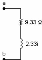
Es posible resolver este problema pasando del circuito original al circuito transformado, donde se indican las impedancias de elementos y aplicar así el método de mallas. El circuito transformado sería el que se muestra a continuación:
